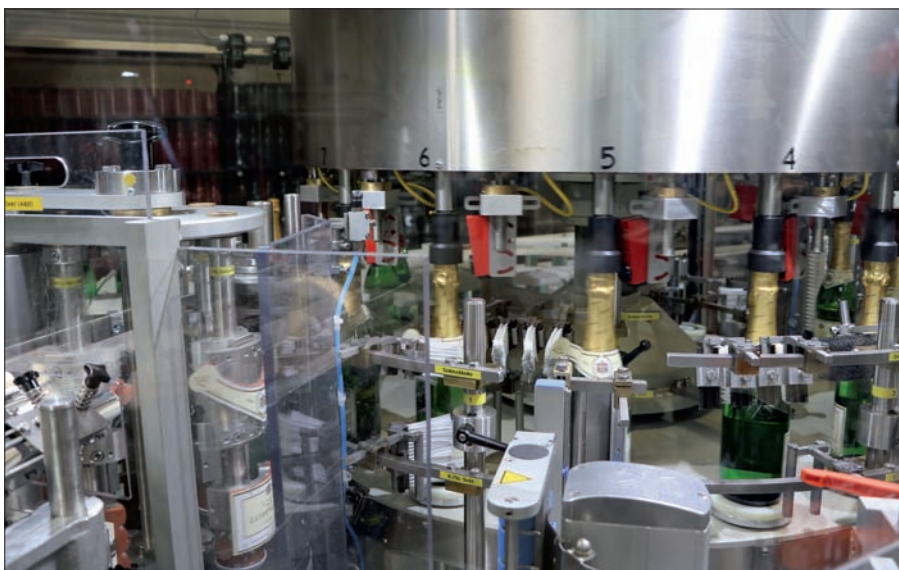
Im Bereich Nassleimetikettierung können derzeit eine Halsschleife, ein Haupt- und ein Rückenetikett aufgetragen werden, die der Kunde vorher selbst gestalten kann.
