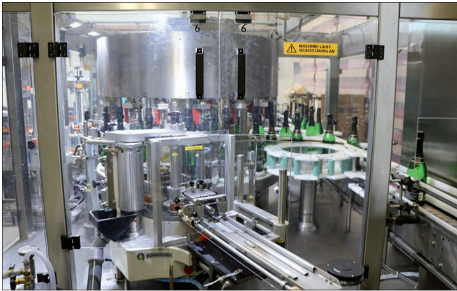
Die Labetta verfügt über zwei Nassleim- sowie zwei Selbstklebeaggregate und ist auf 5 000 Flaschen pro Stunde ausgerichtet.
