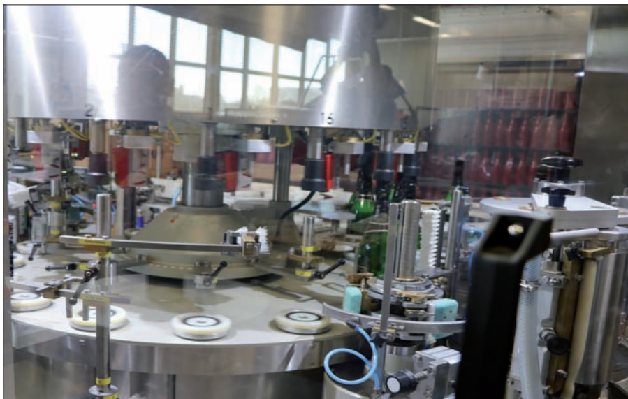
Unter jedem Flaschenteller befindet sich ein servobetriebener Motor, mit dem die Flaschen punktgenau am jeweiligen Klebeaggregat ausgerichtet werden.
