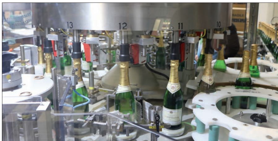
Eine optische Sekt kapsel-Ausrichtung sorgt dafür, dass die Flasche über die Kapsel so gedreht wird, dass der Schriftzug vorne angepasst zu den Hauptetiketten verläuft.
